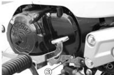
① Πινακίδιο κατασκευαστή ② Αριθμός πλαισίου ③ Αριθμός κινητήρα
