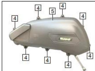
Το όχημα είναι εφοδιασμένο με φίλτρο αέρος. Για να αντικαταστήσετε το φίλτρο, ακολουθήστε την παρακάτω διαδικασία.
